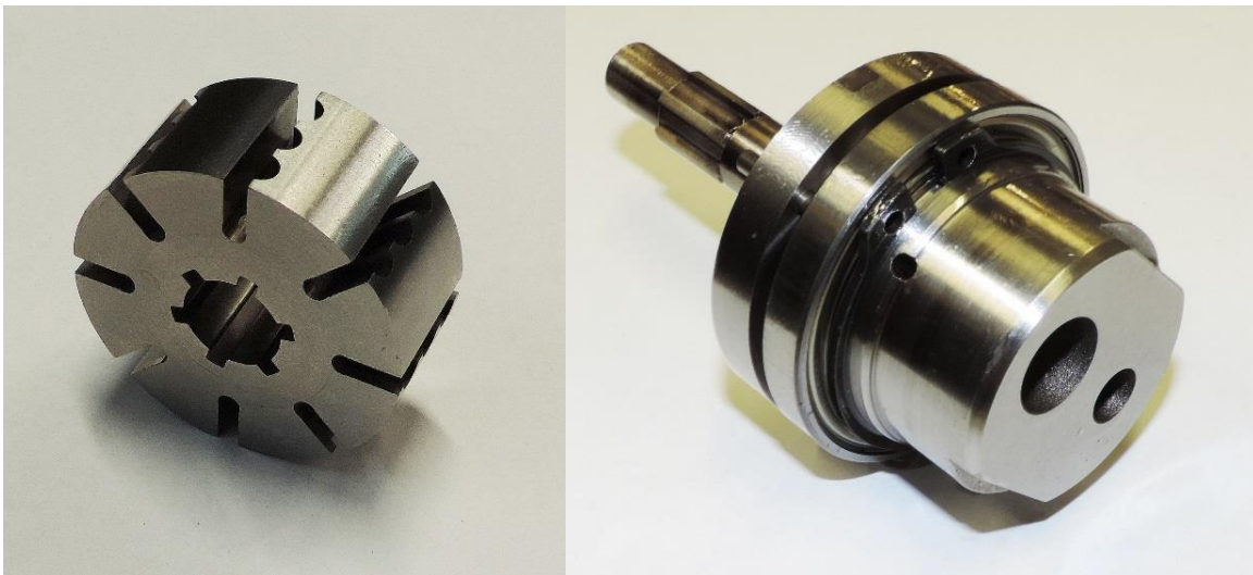
Rys. 2: Wirnik oraz rozdzielacz obrotowy w nowej pompie łopatkowej.
