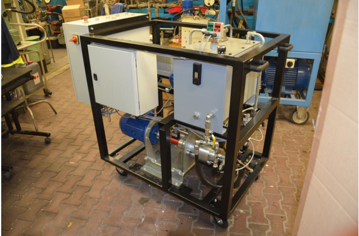
Rys. 3. Stanowisko pomiarowe zespołu silnik- pompa.
